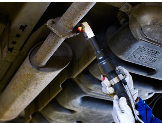
Erhitzen eingerosteter Bolzen und Muttern an Aufhängung und Steuerung
