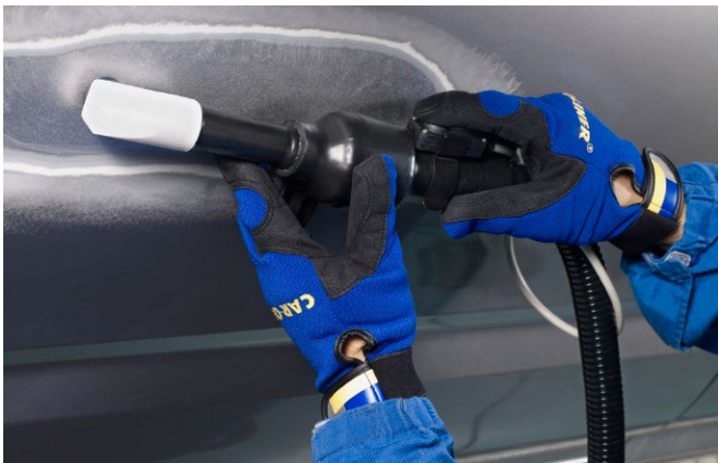
Einziehen von Stahl- und Aluminiumplatten bei Reparaturarbeiten
